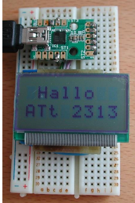
Attiny-Breadboard mit LCD-Modul
